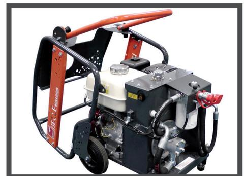
**EL MARCO DE PROTECCIÓN CONTRA INCLINACIÓN HACIA ATRÁS PERMITE UN MANTENIMIENTO DE RUTINA SIMPLE**
